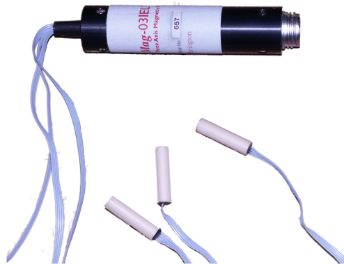
Abbildung 2.18.: Fluxgate-Sensor-Tripel mit der zugehörigen Elektronik. Es kommen zwei solcher Tripel zum Einsatz.
